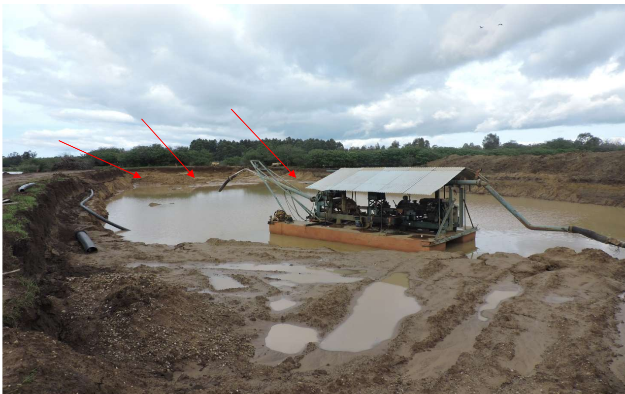
Foto 10- Prosseguido na vistoria. Em foco: área da cava, onde vislumbra-se a extração por sucção (balsa). Notar que nas barrancas (taludes) entrever horizonte com afloramento superficial de minério (areia).
