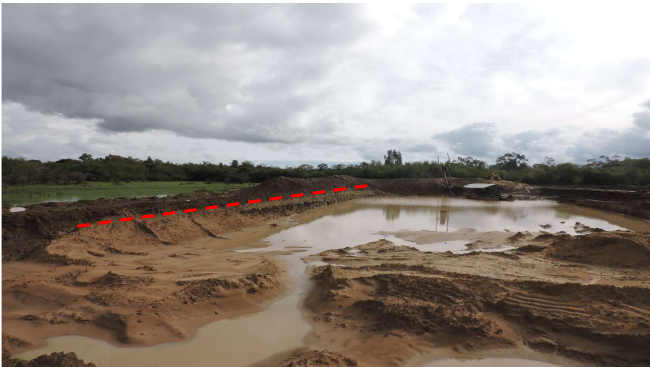
Foto 12- Acompanhando a foto anterior. Em foco: área da cava apresentada à perícia. Notar que nas barrancas (taludes) divisa horizonte com afloramento superficial de minério (areia). Acima dessa linha, horizonte orgânico com meda de 20- 30cm de profundidade.
